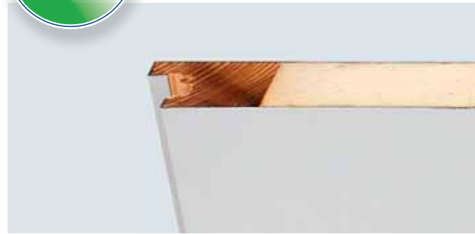
Nagy fokú hőszigetelés a 46 mm vastag, FCKW-mentes PU-keményhabbal kitöltött ajtólapnak köszönhetően.
